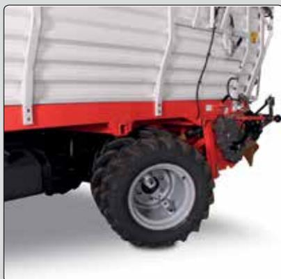
Con PrimAlpin di REFORM è possibile utilizzare di serie la **sterzata integrale** del REFORM Muli. I passaggi stretti, come gli ingressi nei cortili, non rappresentano un problema. Durante la progettazione è stata data particolare importanza alla struttura compatta in prossimità dell'asse.
