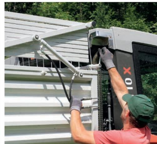
Hydraulisch klappbarer Dürrfutteraufbau und mechanische Aufrollvorrichtung für die Dachseile. Fotos: Paar
