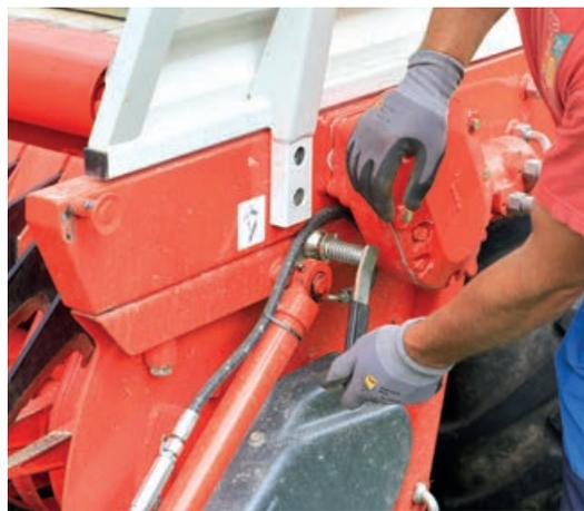
Die Messer-Fixierwelle lässt sich bei verschmutztem Aggregat schwer verdrehen.
