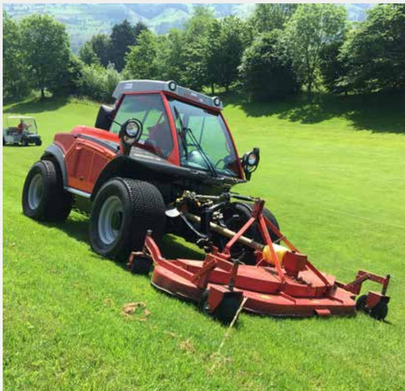
Bodenschonendes Arbeiten mit dem REFORM Metrac H7 X dank geringem Eigengewicht und spezieller Rasenbereifung.
