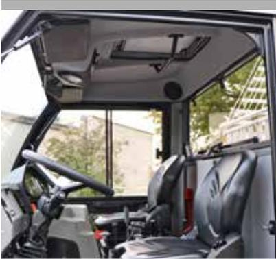
Für die unterschiedlichen Anforderungen stehen längs- und höhenverstellbare **Komfortsitze** mit serienmässigem Beckengurt und neigungseinstellbarer Rückenlehne in 3 Ausführungen zur Verfügung.
