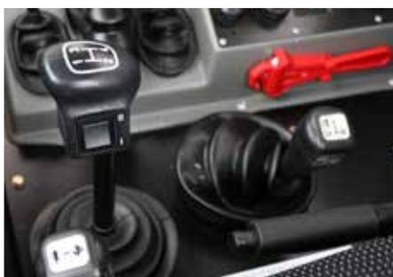
**Die 8 Vorwärtsgänge** werden mit der Splitting-(Halbgang-) Gruppe in 16 Gänge unterteilt und ermöglichen eine noch feinere Geschwindigkeitsabstufung.
