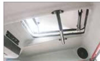
Eine nach allen Seiten ausstellbare **Dachluke** sorgt für ausreichend Frischluftzufuhr.
