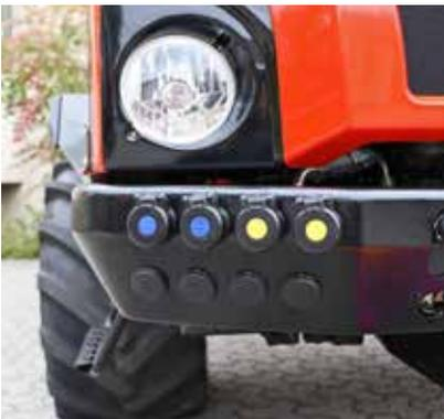
Die **Hydraulik-Steckkupplungen** inkl. Leckölsammler, sind besonders leicht zugänglich, durch die Anordnung seitlich hinter der Kabine und rechts vorne an der Stoßstange. Für einfaches An- und Abbauen von Zusatzgeräten sind die Steckkupplungen mit Symbolen markiert und farblich gekennzeichnet.
