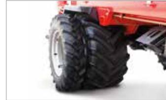
Die **Zusatzbereifung** erhöht die Hangtauglichkeit und Bodenschonung speziell bei feuchten Bodenverhältnissen.
