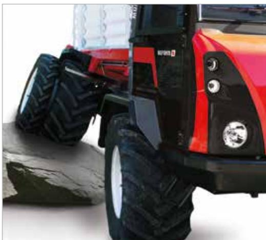
Das spezielle Geländefahrwerk der Muli Mittelklasse sorgt für extreme Hangtauglichkeit bei gleichzeitiger Grasnarbenschonung. Die optimale Boden Anpassung wird durch die Zentralrohrbauweise mit Drehgelenk erzielt. Die robusten Portalachsen sorgen für enorme Bodenfreiheit und besten Schutz des Antriebsstranges.
