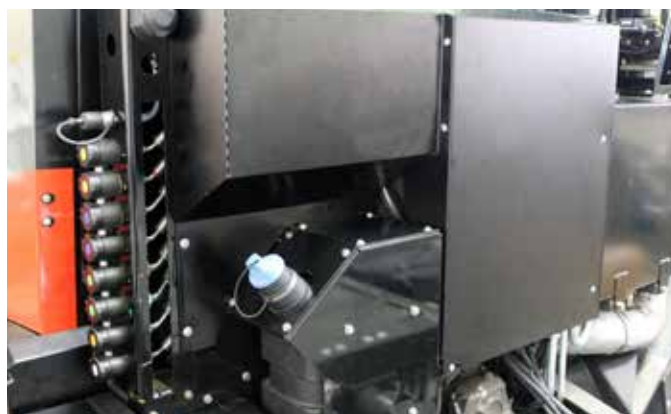
Neu konzipierter Technikraum mit AdBlue-Tank
