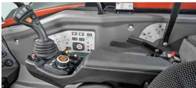
logique des commandes et les écrans d'information faciles à lire permettent de conduire sans fatigue pendant de nombreuses heures. Associé à l'accoudoir ergonomique et au joystick multifonction, le siège confort éprouvé crée un poste de travail conçu de manière optimale pour le conducteur. Un autre point fort est l'excellente isolation phonique : avec seulement 68 dB lorsque la cabine est fermée, le nouveau Metrac H95 est d'un silence inégalé.
