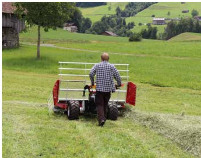
Resultat: Rückstandslose Aufnahme und aktiver seitlicher Abtransport
